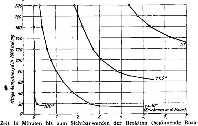
Die Kurven zeigen die Abhängigkeit der Reaktionsgeschwindigkeit (Äthylenoxyd — 40% Kaliumrhodanidlösung) von der Temperatur und der absoluten Äthylenoxydmenge.
